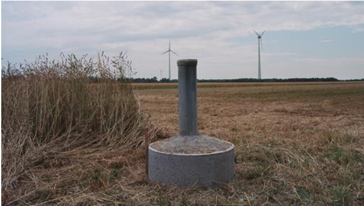
Abbildung 29: Grundwasserkörper Marchfeld [DUJ]: Grundwassermessstelle zur Beweissicherung nahe Obersiebenbrunn, Niederösterreich.
