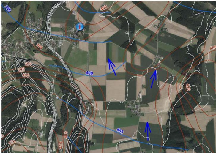
Abbildung 5: Naturräumliche Verhältnisse im Einzugsbereich des Brunnens (mit blauer Stecknadel markiert). Die Grundwasserströmungsrichtung ist mit blauen Pfeilen gekennzeichnet. Neben den Höhenlinien des Stauerreliefs in braun, sind auch die Höhenschichtenlinien des Grundwassers ersichtlich.
